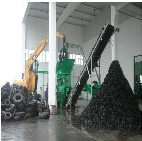
*создание нового производства и рабочих мест. Предусматривается приобретение и установка линии по переработке шин в крошку методом механического измельчения, что позволит получить на выходе резиновую крошку, текстильный корд и металлический корд. Это недорогой, экологически безопасный, быстроокупаемый способ утилизации отходов резины.*
